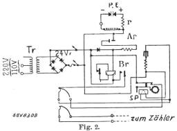
Schaltschema des Zählapparates für einen Eingang mit schwachem Verkehr.
