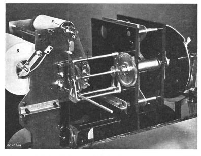
Tischplatte (E in Fig. 1) ist ein Schlitz frei gelassen, in den die mit Lux-Skala versehene Karte eingeführt wird. Die Skala auf der Karte entspricht den verschiedenen Beleuchtungsstärken, die sich durch verschiedene Blendenstellungen und die entsprechende Abeichung ergaben. Koaxial zur Dreh-
