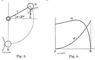
Punkt A Null sein, obwohl das Drehmoment gross ist, im Punkt B dagegen ein Maximum werden, obwohl hier das Drehmoment Null geworden ist. Genau gleich liegen die Verhältnisse beim Anlauf eines Motors. Ein Motor mit Kurzschlussanker entwickelt ein Drehmoment, dessen charakteristischer Verlauf mit der Kurve M gut übereinstimmt. Der durch das plötzliche Auftreten des Drehmomentes am Beginn der Bewegung mögliche Stoss ist beim Motor genau so wie bei dem dargestellten Pendel Null.
