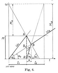
wird, ist somit gleich M, d. h. das ganze vom Motor ausgeübte Drehmoment wird beim Stoss zur Beschleunigung der Masse  $m_2$  verbraucht, während die Masse  $m_1$ , solange der Stoss dauert, in der gleichen Winkelgeschwindigkeit verharrt.
