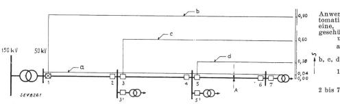
Anwendung der unverzögerten automatischen Wiedereinschaltung auf eine, mittels Maximalstromrelais geschützte, in mehrere Abschnitte unterteilte Stichleitung.
