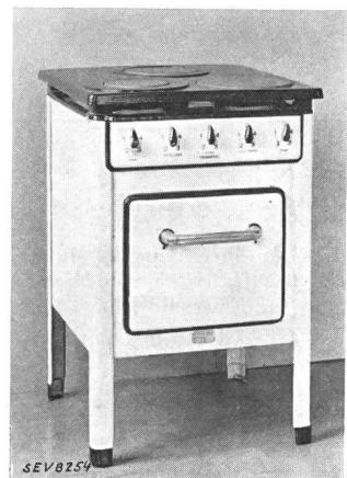
Description: Cuisinière de ménage selon figure, à trois trous et four en-dessous de ceux-ci. Les corps de chauffe du four sont montés en dehors de celui-ci. Les plaques, de 145, 180 et 220 mm de diamètre, sont en fonte grise et munies de dispositifs de contact normaux. La cuisinière est émaillée crème et noir.
