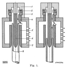
Schaltkammer des Hartgasschalters.
