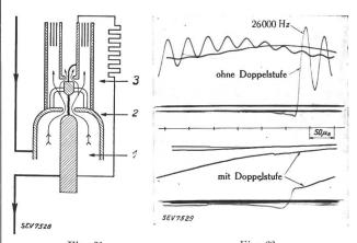
Fig. 21. Doppelstufige Lichtbogen-löschung mit hohlen Kontakten. 1 Luftzufuhr, 2 Löschkon-takt, 3 Funkenstrecke.
