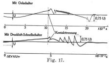
Spannungsverlauf über einem Transformator beim Unterbrechen des Leerlaufstromes.
