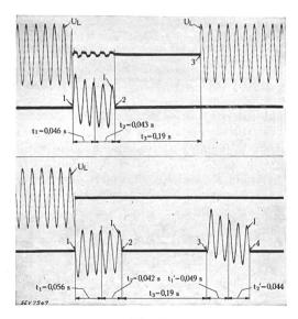
Fig. 40. Oszillogramm des Aus- und Wiedereinschaltens mit dem 150-kV-Druckluftschnellschalter.
