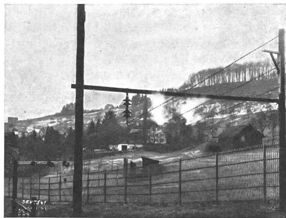
Fig. 34. Versuchsanordnung zur Bestimmung der Entionisierungszeiten von Kurzschlusslichtbogen auf Freileitungen.
