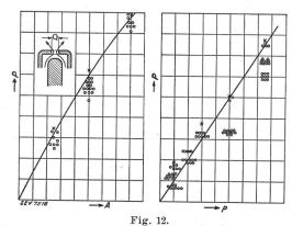
Einfluss des Strömungsquerschnittes A und des Betriebsdruckes p auf die Abschaltfähigkeit P von hohlen Kontakten.
