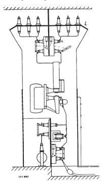
vom Felde trennen, oder durch Isolation entsprechender Leitungsstücke, z. B. bei den ankommenden Feldern. Zwei Sammelschienensysteme, verschiedenen Betrieben angehören können, sollten mit ihren Trennern immer durch eine Schutzwand getrennt werden.
