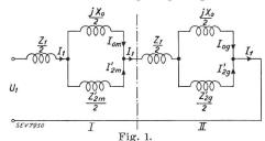
Fig. 1. Ersatzdiagramm des einphasigen Asynchronmotors.
