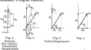
Die Gleichung für die Serieschaltung (Index Y) der Spulen- und Kondensatoren-Impedanzen lautet:
