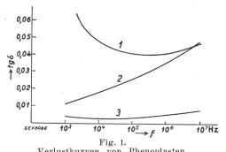
Verlustkurven von Phenoplasten.
