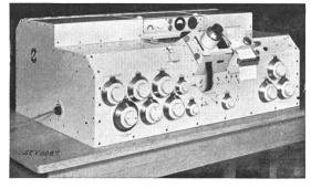
Fig. 2. Rechengerät für die Fliegerabwehrartillerie.
