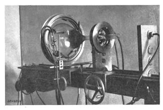
Fig. 8. Glaskolben für Fernsehempfangsröhren auf der Verschmelzmaschine.
