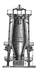
Fig. 1. Kokshochofen, schematischer Schnitt.
