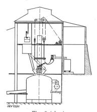
Fig. 3 (oben). Elektrischer Niederschachtofen, schematischer Schnitt.
