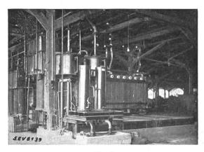
Fig. 8. Filterpresse-Elektrolyseur.
