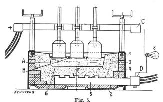
Zelle für Aluminium-Elektrolyse für 8000 A.
