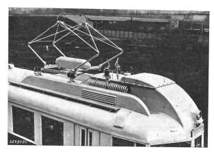
Fig. 8. Transformator mit Röhrenkessel in Triebwagendach eingebaut. (Sécheron.)
