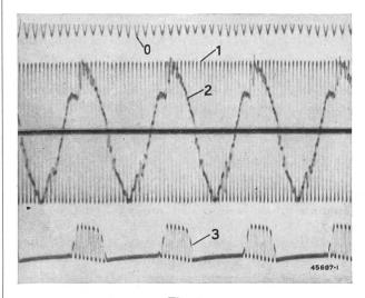
Strom- und Spannungs-Verhältnisse eines Dreiphasen-Einphasen-Mutators bei der Speisung einer 1000-Hz-Induktionsofens.
