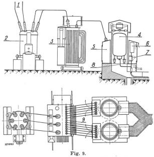
Projekt eines Freiluftmutators. 1000 kW, 750 V.
