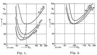
Kostenkurven für Drehstromtransformatoren 50 Hz, 100 kVA, 10 000/400 V, Stern/Zickzack.
