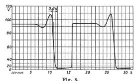
Spannungsaufbau am Erreger mit Brown-Boveri-Hochleistungs-Oeldruck-Schnellregler.
