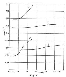
Verlustwinkel in Abhängigkeit von der Spannung.
