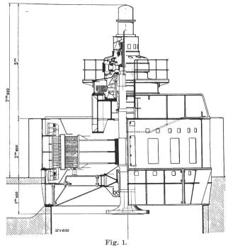
Drehstromgenerator für das Kraftwerk Verbois, Genf. 27 500 kVA, 18 000 V, 136 U/min. (Sécheron.)
