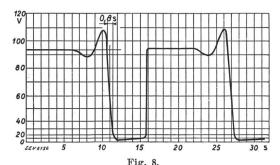
Spannungsaufbau am Erreger mit Brown-Boveri-Hochleistungs-Oeldruck-Schnellregler.
