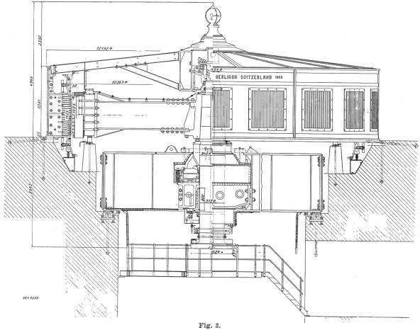
Drehstromgenerator für das Kraftwerk Beauharnols (Kanada). 44 000 kVA, 13,2 bis 14,5 kV, 25 Hz, 75 U/min. (Maschinenfabrik Oerlikon.)
