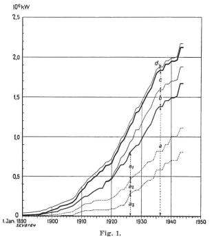
Ausbauleistung aller Wasserkraftwerke.
