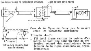
Fil nu d'une section de cuivre d'au moins 6 mm² tiré dans un tube ou fixé à des poulies en porcelaine, indépendamment des conducteurs basse tension de la ligne d'amenée au trans-
