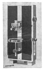
Description: Percolateur selon figure, du type chauffe-eau instantané. Le boudin de chauffe, de 40 cm de longueur environ, est en contact direct avec l'eau qui le traverse. Un verrouillage entre l'interrupteur et le robinet empêche que l'appareil soit enclenché à robinet fermé. L'appareil est prévu pour montage mural et raccordement fixe.
