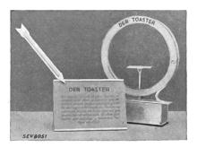
Description: Appareil de réclame lumineuse selon figure. Sur la flèche et l'anneau sont disposées de petites lampes à incandescences masquées par du papier parcheminé et alimentées par un transformateur. Un dispositif de commutation entraîné par un moteur allume et éteint les lampes l'une après l'autre, de façon à donner l'impression que la lumière voyage. Un commutateur spécial permet d'enclencher la flèche et l'anneau séparément, simultanément ou alternativement.
