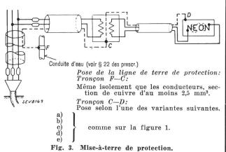
Ligne de terre de protection tirée dans le même tube que les lignes d'amenée au transformateur.
