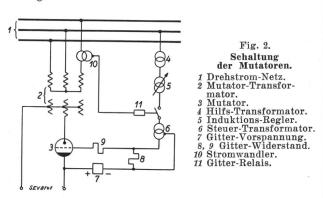
Die Inbetriebsetzung der Anlage erfolgt von der Sekundärseite her, indem vorerst der Gleichstrom-Drehstrom-Mutator an das zu speisende Drehstromnetz der Stadt Zürich angelegt und sodann erst der Drehstrom-Gleichstrom-Mutator im Werk Wettingen zugeschaltet wird. Die Ausserbetriebnahme geht
