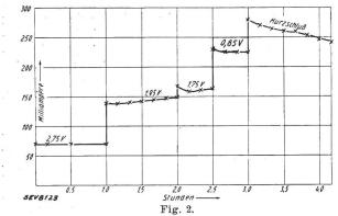
Stromlieferung in Milliampère-Stunden in Abhängigkeit von der Klemmenspannung bei einer Batterie von 5 Brennstoffelementen, die zusammen 225 cm³ Raum einnehmen.
