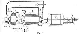
Schema einer Gasturbinenanlage. 1 Luftverdichter. 2 Brennkammer. 3 Oelflamme. 4 Turbine.
