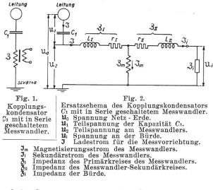
Kopplungs-kondensator C<sub>1</sub> mit in Serie geschaltetem Messwandler.
