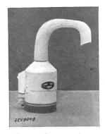
Description: Ventilateur avec filtre à absorption selon figure, pour la désodorisation des W.C., etc. Soufflante entraînée par moteur série mo-nophasé. L'air est aspiré par une tubulure en caoutchouc, longe une enveloppe métallique entourant le fer du moteur et quitte l'appareil à travers le filtre. Carcasse en matière isolante moulée en deux pièces. Appareil prévu pour raccordement fixe; bornes couvercle métallique sous vissé.
