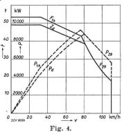
Zugkraft und Leistungslinien, Dauerzugkraft in Tonnen am Rad. Stundenzugkraft in Tonnen am Rad. Leistungen in kW an den Motorwellen. Zugkraft, bzw. Leistung auf der höchsten Fahrstufe.
