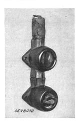
pour locaux humides) et de câbles sous plomb avec tresses incorrodables posés eux-mêmes dans des tubes de protection en cuivre. La jonction des tubes de cuivre et des interrupteurs avait été réalisée par des manchons filetés, en acier, vissés d'une part aux tubes de cuivre et d'autre part dans les entrées des boîtiers d'interrupteurs.
