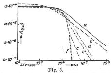
Amplitudenspektren, bzw. deren Umhüllende für die in Fig. 2 dargestellten Impulse.  $A(\omega)$  Teiltonamplitude.  $\omega$  Kreisfrequenz.
