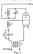
Schema eines in tonfrequentem Takte tröpfelnden Hochfrequenzgenerators.
