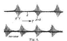
Oszillogramme eines in niederfrequentem Takte tröpfelnden  $1000 ext{-}$ Hertz-Generators.
