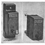
Description: Disjoncteurs d'installation unipolaires à socle, selon figure, à déclenchement thermique et électromagnétique. Commande par boutons poussoirs. Sectionneur du neutre verrouillé avec le bouton d'enclenchement. Socle en matière céramique, cape et boutons en matière isolante moulée.
