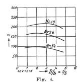
Experimentell aufgenommene Kurven zur Darstellung von Q als Funktion des Verhältnisses Durchmesser : Länge (D/b). Konstant gehaltene Spulendaten:  $L=3,6~\mu\mathrm{H},~f=13~\mathrm{MHz}.$   $b=1,5~\mathrm{cm}.$
