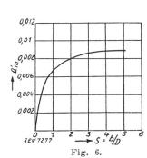
Abhängigkeit des Faktors Q vom Verhältnis Länge: Durchmesser b/D bei optimalem Drahtdurchmesser und konstantem Spulendurchmesser. Theoretische Kurven.
