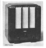
Description: Appareil de télédiffusion selon figure. Un étage amplificateur. Régulateur de puissance, régulateur de tonalité et sélecteur de programme. Transformateur de réseau commutable pour 125, 150, 220 et 250 V. Prise pour second haut-parleur.
