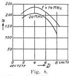
Abhängigkeit des Q vom Spulendurchmesser, wenn das Verhältnis Länge: Durchmesser (b/D) und der Drahtquerschnitt konstaut gehalten werden. Spulendaten: Länge: Durchmesser 2,8.  $L=1,1~\mu\mathrm{H}.~d=0.081~\mathrm{cm}.$
