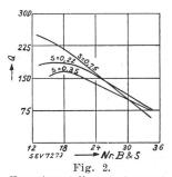
Experimentell aufgenommene Kurven zur Darstellung von Q als Funktion des Drahtdurchmessers (d). Spulendaten:  $L=1,1~\mu\mathrm{H},~f=20~\mathrm{MHz},~D=2,5~\mathrm{cm}.$
