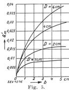
Abhängigkeit der Grösse Q von Länge b und Durchmesser D der Spule bei optimalem Drahtdurchmesser.
