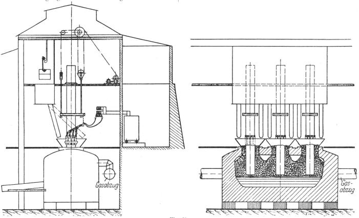
Fig. 21. Schema des Tysland-Hole-Ofens.
