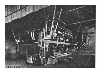
Fig. 22. Geschlossener Dreiphasenofen für Roheisen, System Tysland-Hole, 7200 kVA.
