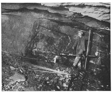
Fig. 15. Gonzenbergwerk: Bohrmaschine im Erzabbau.
