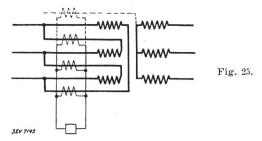
sortir deux des trois liaisons entre phases. Le TI 3 a un rapport  $\sqrt{3}$  fois plus petit que les TI 1 et 2. On vérifie aisément qu'en service normal la somme des trois courants secondaires sur le relais est nulle, pour le couplage 25 comme pour le couplage 26.
