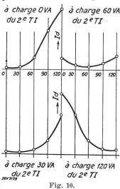
à charge 60 VA fie, pour les transformateurs modernes travaillant à induction élevée, un appel de courant magnétisant considérable dans la phase saine (par exemple pour un transformateur travaillant à 14 000 gauss, une élévation de tension de 10 % fait monter le courant magnétisant de 4 à 20 %, ce qui peut suffire à actionner le relais différentiel.
