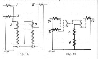
Par exemple, dans le cas mentionné plus haut, d'un courtcircuit sur (2), avec alimentation par (1), les bobines de déblocage reçoivent bien le courant d'erreur, mais la bobine de retenue du relais A reçoit le courant total de dé-
