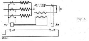
δ) Si la mise à la terre du neutre (par résistance) se fait non pas aux alternateurs, mais à un transformateur, chaque alternateur peut être considéré comme un départ; il suffit d'un relais de terre directionnel, de couplage analogue à celui du relais RD de la fig. 5 (alimenté par la somme des courants et la tension du neutre).  $\varepsilon)$  Toutes ces solutions ne détectent pas une mise à la masse dans le voisinage du neutre.
