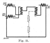
faut. Donc, pour un défaut externe, même si l'un des deux relais vient à débloquer sous l'effet des courants d'erreur des TI, l'autre ne débloque pas. Comme leurs contacts sont en série, il ne peut se produire de déclenchement intempestif. Pour un défaut dans le transformateur par contre, les deux relais fonctionnent.
