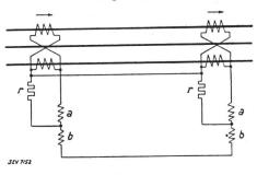
montage différentiel dit à équilibre de tension, au lieu du montage précédent à équilibre de courant, ceci afin d'économiser un fil pilote. On compare les chutes de tension dans deux résistances r au départ et à l'arrivée. a et b désignent les deux bobines du relais. Il ne circule pas de courant en régime nor-
