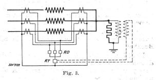
On peut y remédier en adjoignant au relais un enroulement de tension, qui en fait un relais directionnel; il bloque alors à court-circuit externe.
