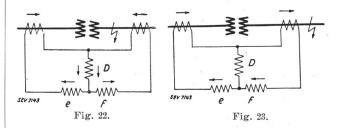
rants de sens opposé, le relais est maintenu en repos. Si un seul des TI a du courant, c'est-à-dire une seule des bobines, e ou f, le relais est maintenu également en repos par un ressort.
