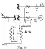
de déblocage égal à une frac-(3) tion seulement de celui de la bobine antagoniste. adopter le couplage de la fig. 19 comportant deux relais par phase, A et B. Le principe du couplage est le suivant: La somme des courants secondaires des TI doit être nulle en service normal, ou pour un courtcircuit externe. Les bobines de déblocage des deux relais mesurent cette somme. Etant couplées en série (fig. 20), elles ne reçoivent que le courant d'erreur. Les bobines de re-
