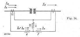
fonctionner. On voit en effet, d'après la fig. 24, que le relais (ef) est parcouru par  $(I_{\mathbb{K}}+I_{\mathbb{N}})$  et  $(I_{\mathbb{N}})$ . Or on a vu que, pour un court-circuit entre spires,  $I_{\mathbb{K}}$  devient assez élevé et par suite le produit  $I_{\mathfrak{o}} \cdot I_{\mathfrak{l}}$  atteint vite la valeur critique  $1,5 \cdot I_{\mathbb{n}}^2$ .
