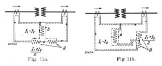
principe, la fig. 11b le couplage schématique du relais; a est la bobine antagoniste (consistant en deux demi-bobines), b la bobine de déblocage. La première est parcourue, en service normal, par  $\left(\frac{I_1+I_2}{2}\right)$  la deuxième par  $(I_1-I_2)$ . Lorsqu'on a une surcharge ou un court-circuit externe et que le courant
