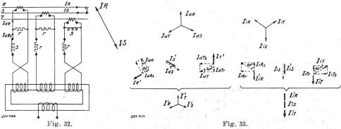
en cas de défaut extérieur au tronçon; pour un défaut interne par contre, la grille devient positive à plaque positive, un courant discontinu traverse la lampe, le relais R est actionné et déclenche instantanément.
