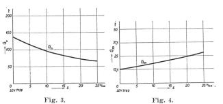
Nutzgewichte in Motorwagen-Zügen bei gegebenem Gewicht gewichte für Motorwagen-Züge der motorischen Ausrüstung. mit gegebener Zugskomposition.
