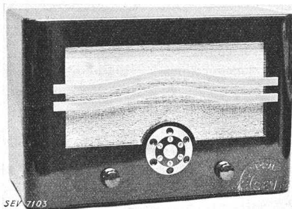
**Description:** Appareil de télédiffusion selon figure. Deux étages d'amplification. Régulateur d'intensité du son, régulateur de volume et commutateur de programme. Transformateur de réseau commutable pour cinq tensions primaires différentes. Appareil utilisable comme amplificateur de gramophone. Prise pour raccordement d'un second haut-parleur.
