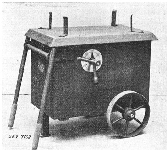
*Description:* Transformateur de soudure mobile selon figure. Enroulement primaire commutable pour 250, 380 et 500 V. Tension de soudage 25 V. Réglage continu du courant de soudage de 25 à 85 A et de 80 à 200 A. Pour améliorer le facteur de puissance, 4 condensateurs d'une capacité totale de 39,2  $\mu$ F sont insérés dans le circuit primaire.
