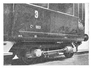
Kardanantrieb des Zugsbeleuchtungsgenerators an einem Leichtstahlwagen der SBB.
