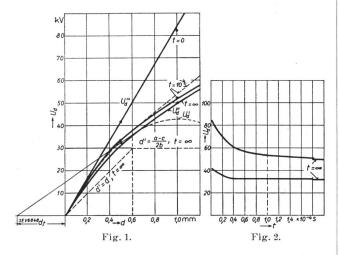
fort; die Nachgiebigkeit des Stoffes dürfte auch zu einer Verbreiterung der Berührungsstellen beigetragen haben. Daher sei das Messergebnis an Hartgummi hier herangezogen. In Fig. 1 ist zunächst eine Gerade aus dem Ursprung gezogen, die den Messwerten der Durchschlagspannung bei  $t=10^{-8}\,\mathrm{s}$  entspricht. Sie wird mit der Durchschlagsfunktion
