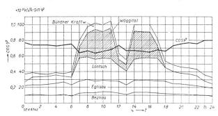
Fig. 4. Diagramme de la puissance réactive du réseau des NOK et de sa répartition entre les diverses entreprises cantonales, le mardi 31 juillet 1928. Le trait plus épais indique l'allure du cos  $\varphi$  de la charge du vécusie.
