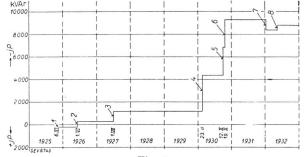
Modification de la puissance réactive du réseau des NOK lors de la mise en service des lignes à très haute tension et des transformateurs correspondants, de 1925 à 1933.
