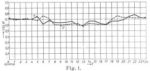
Diagramme du cos  $\varphi$  du réseau des NOK en 1926, valeurs mesurées aux points de production et aux points de réception de l'énergie étrangère.
