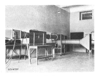
Fig. 18. Ventilatorprüfanlage, rechts Luftfilter, links 40-kW-Heizkörper.
