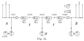
Prinzipschema des «Kraftwerkbetriebslaboratoriums». Zwei Drehstromelektrizitätswerke, jedes Werk mit lokaler Energieverteilung (für konstante Spannung). Beide Werke verbunden durch eine künstliche Fernleitung mit R, L und C, dazu Phasenschieber, Kupplungstransformator mit Anzapfungen und Induktionsregler.
