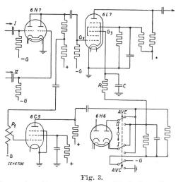
Teilschema eines Tonverstärkers mit Mischröhre 6N7 und Einrichtung zur wahlweisen Einschaltung von Kontrastexpansion (AVE) oder automatischer Lautstärkeregulierung (AVC).
