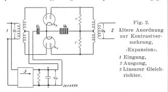
geben; beides zusammen wurde als «Compandor» bezeichnet. In Fig. 1 wirken die Röhren nur durch ihren veränderlichen Widerstand; in Fig. 2 wird der Verstärkungsgrad geändert. Während man heute Mehrgitterröhren verwendet, versuchte man damals mit Trioden auszukommen. Die Anordnung komprimierte eine Dynamik von 45 db auf 22,5 db und es musste also die frühere Handregulierung trotzdem beibehalten werden. Die komprimierte Sprache klingt etwas unnatürlich.
