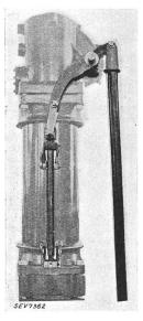
Fig. 2. Oelstrahlschalter für Innenraum. Mechanismus.
