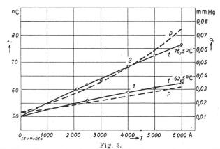
Sattdampftemperatur t und Dampfdruck p an der Anode (1) und an der exponierten Stelle (2) im Mutator für 6000 A in Abhängigkeit vom Strom bei 50°C mittlerer Kühlwassertemperatur.
