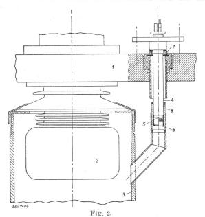
Einbau des Kondensationsdampfdruckmessers zum Messen im Anodenraum.
