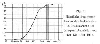
1500 kHz streut also die Fahrdrahtimpedanz in den Grenzen von 25 bis 1800 Ohm; 50 % aller Werte liegen über bzw. unter 200 Ohm.
