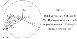
Diese Kreisbogen gehen im Grenzfall, wenn kein Elektrokessel im Netz eingeschaltet ist  $(R = \infty)$ in einen Halbkreis über & über (Fall des direkten Erdschlusses in einem Netz ohne Elektrokessel). In den meisten Netzen wird es so sein, dass der kapazitive
