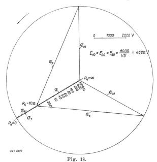
Ortskurve des Vektors  $\mathfrak E$  für direkten Erdschluss in einem 8-kV-Netz mit angeschlossenem Hochspannungselektrokessel von 1000 kW Leistung (R=64).
