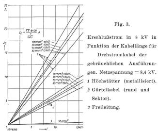
dem Erdschlußstrom ganz besondere Beachtung geschenkt werden, eventuell muss dieser durch Einbau von Löschspulen in erträglichen Grenzen gehalten werden.
