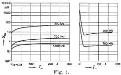
Typische Störkennlinien. Störspannung in mV in Funktion der Gleichstrombelastung in A von zwei verschiedenen Gleichrichteranlagen.
