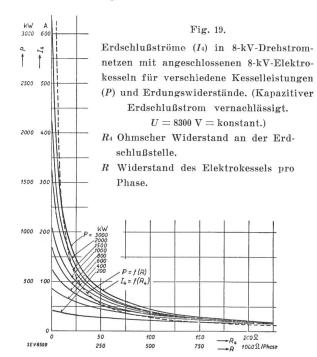
lassen werden. Sobald nämlich eine Phase des Netzes Erdschluss hat, steigen die Kesselströme in den übrigen zwei Phasen, so dass die Maximalstromrelais den Schalter zum Auslösen bringen. Solche Elektrokessel findet man in der Praxis allerdings
