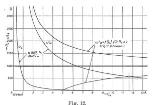
Erdschluss am Nullpunktschalter eines einphasig an Spannung liegenden 145-kVA-Drehstromtransformators. (Sternschaltung 8240 V.)
