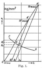
Die bleibende Dehnung vergrössert den Durchhang der Freileitungsseile 1). Je nach Material und Spannweite kann der Durchhang dabei unzulässig gross werden und es muss für Abhilfe gesorgt werden.
