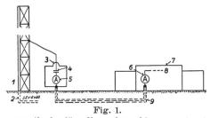
Kopplungsmethode für die nebenschlusserregte Antenne.
