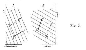
La figure 2 montre bien l'avantage qu'il y a à incliner les caractéristiques de réglage conformément aux statismes individuels de chaque réseau.
