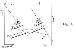
Le diagramme de la figure 3 a ceci de commun avec le diagramme de la figure 1 que les deux diagrammes s'approchent du point O asymptotiquement seulement. Pour arriver à la netteté du diagramme de la figure 2, il ne suffira donc pas d'incliner les caractéristiques de réglage, mais il faut en plus que les caractéristiques de réglage s'accordent aux statismes dans chaque réseau individuellement.
