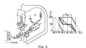
Leistungs-Sollwert-Steuerapparat mit Frequenzüberwachung.
