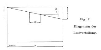
Fig. 2 seien diese Verhältnisse kurz erläutert.  $reve{P}$  stellt die gesamte Netzleistung dar,  $\Delta P$  die vom frequenzhaltenden Werk lieferbare Energie.
