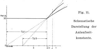
Generator-Aggregates in dieser Hinsicht durch die Grösse der sogenannten Anlaufzeitkonstante, das ist die Zeit, welche nötig ist, die Gruppe mit normalem Drehmoment vom Stillstand auf die normale Drehzahl zu beschleunigen und welche gegeben ist durch
