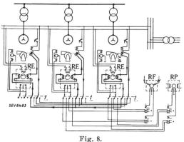
Schema der Lastverteileinrichtung.
