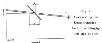
bei kleinen Werten. Im Grenzfall, d. h. bei astatischer Frequenzregulierung (z. B. mit Isodrom-Reglern) ist die Lastverteilung labil. Es scheint darum naheliegend, bei Frequenzhaltung, wo mehrere Maschinen oder Werke parallel arbeiten, mit höheren Statikwerten die sichere Lastverteilung zu erzwingen und mit Zusatzeinrichtungen dafür zu sorgen, dass die durch die höhere Statik bedingte Frequenzabweichung kompensiert wird.
