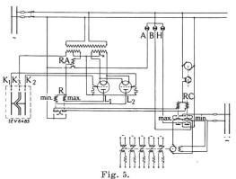
Schema der Leistungs-Programmsteuerung.
