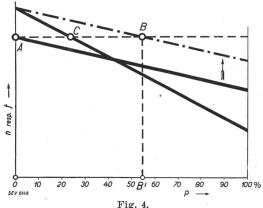
Lastaufnahme nach dem Parallelschalten.
