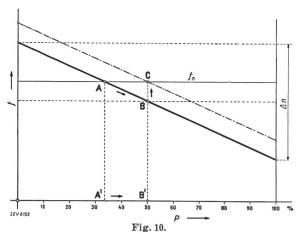
Laständerung durch «Drehzahlverstellung».
