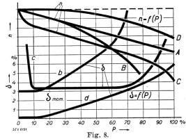
Drehzahlcharakteristiken und Ungleichförmigkeitsgrade.
