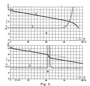
Drehzahlcharakteristiken und Ungleichförmigkeitsgrade.
