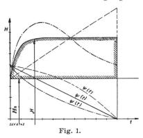
Diese Tatsache hat sich der amerikanische Ingenieur Gibson zunutze gemacht und vorgeschlagen, die Gleichung (5) zur Durchführung von Wassermessungen zu benützen. Es wird der Verlauf der Ueberdruckhöhe in Funktion der Zeit experimentell aufgenommen und der Wert des Integrales graphisch bestimmt. Mit Hilfe der Kontinuitätsglei-
