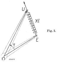
terne E, reliée au réseau d'interconnexion en un point de raccordement où la tension est U, par une chaîne de réactances de valeur totale X.
