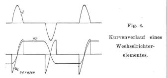
Die zur Entionisierung der Entladungsgefässe erforderliche Zeit legt für den normalen Speicherwechselrichter eine obere Frequenzgrenze fest; sie liegt bei etwa 2000 Hz. Es gelingt aber trotzdem, auch höhere Frequenzen zu erzeugen, und zwar dadurch, dass die Leistungskreis-Eigenfrequenz grösser gewählt wird als die Steuerfrequenz. Die Spannun-
