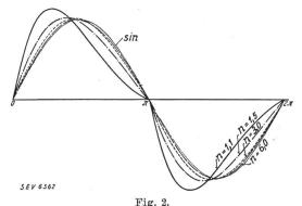
Verlauf des erzugten Wechselstromes.
