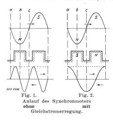
den Anfangswert von 1440 U/min verzögert, und so fort, wobei auf jede Schlupfperiode zwei beschleunigende und zwei verzögernde, also im ganzen vier Kraftimpulse entfallen. Hat der Motor dagegen den Synchronismus erreicht, so verwandelt sich die Zugkraft-Kurve in die gestrichelte, gerade Linie, die auf der Höhe des Maximalwerts der Kraftimpulse verläuft. Diese Linie stellt das Kippmoment des Synchronmotors dar.
