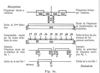
Spectre de fréquence d'une transmission radio-téléphonique à 9 voies.
