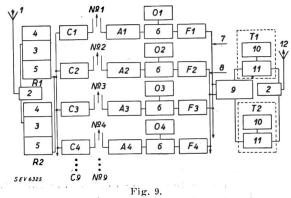
Schéma de principe d'un équipement multiplex à 9 voies.
