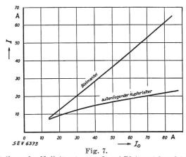
Aufteilung des Nulleiterstromes  $I_0$  auf Bleimantel und äusseren Kupferleiter bei Parallelschaltung der beiden. Die Teilströme sind gegeneinander phasenverschoben. Es ist z. B. für  $I_0=50~\mathrm{A}$ ,  $I_{cu} = 17 \text{ A}, I_{m} = 36,5 \text{ A}.$
