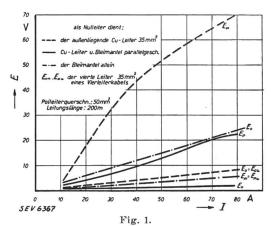
Spannungsabfall E, im Polleiter und E, im Nulleiter, bei einphasiger, ohmscher Belastung.
